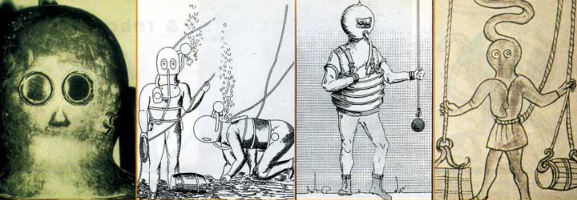
Da sinistra a destra: uno dei primi caschi dei fratelli Deane ottenuto dalla modifica di un casco da fumo; scafandro di Fraser; scafandro di William James (1825); un cappuccio per immersione da una stampa del 1430. Fu l'esigenza di entrare in locali invasi dal fumo, in seguito a un incendio, a far nascere l'idea base del casco da palombaro. Nella pagina a lato, palombari al lavoro sul relitto di un sommergibile, con caschi chiusi e scafandro elastico
